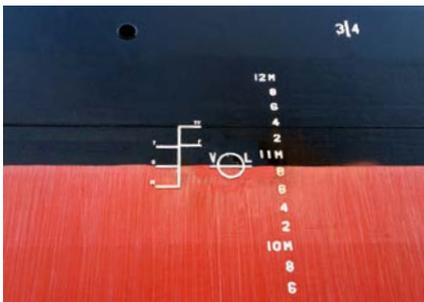
*Welche Klasse ein Schiff hat, verrät eine Buchstabenkombination beidseits in der Schiffsmitte an der „Freibordmarke“*
