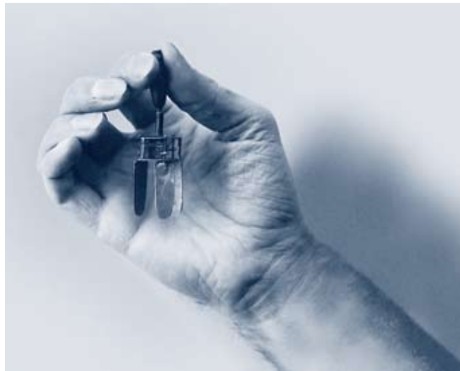
1927, Handmodell eines Voith-Schneider-Propellers.
