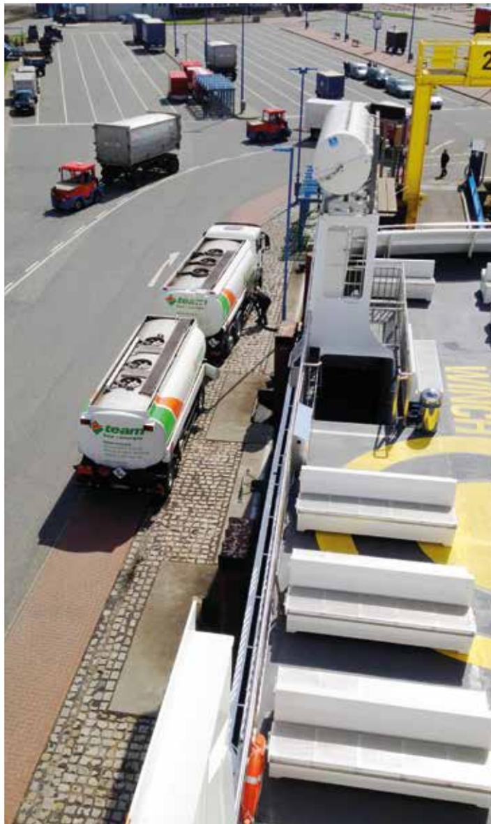
*Bebunkerung per LKW in Dagebüll-Mole mit einem speziellen schwefelarmen Dieselmotorenkraftstoff für Schiffsmotoren.*
